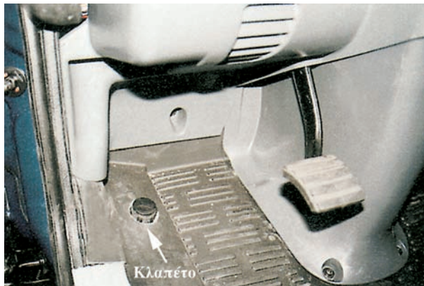
Σχ. 9.34 Μηχανόφρενο κλαπέτο.
