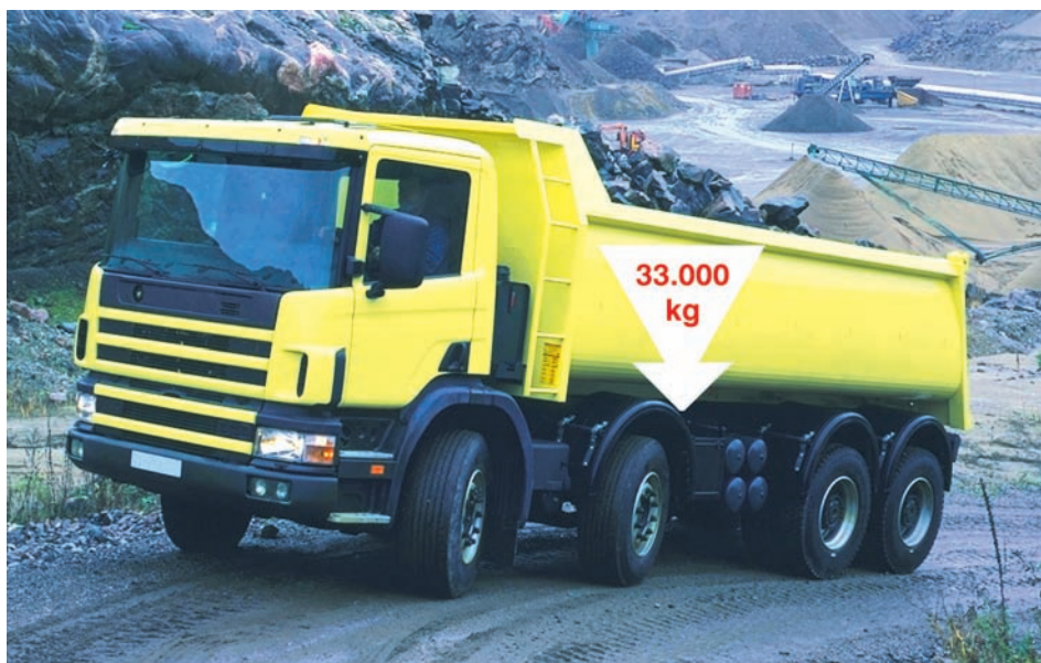
Σχ. 1.17 Μέγιστο επιτρεπόμενο βάρος τετραξονικού φορτηγού.
